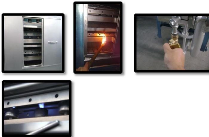
**C-3. Máquinas con encendido automático:** Se abre la llave de paso del gas, se aprieta el botón de encendido automático, se espera cinco segundos. Se verifica que prendan todas las boquillas.
